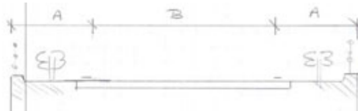
principe dwarsprofiel brug zonder fietspad
